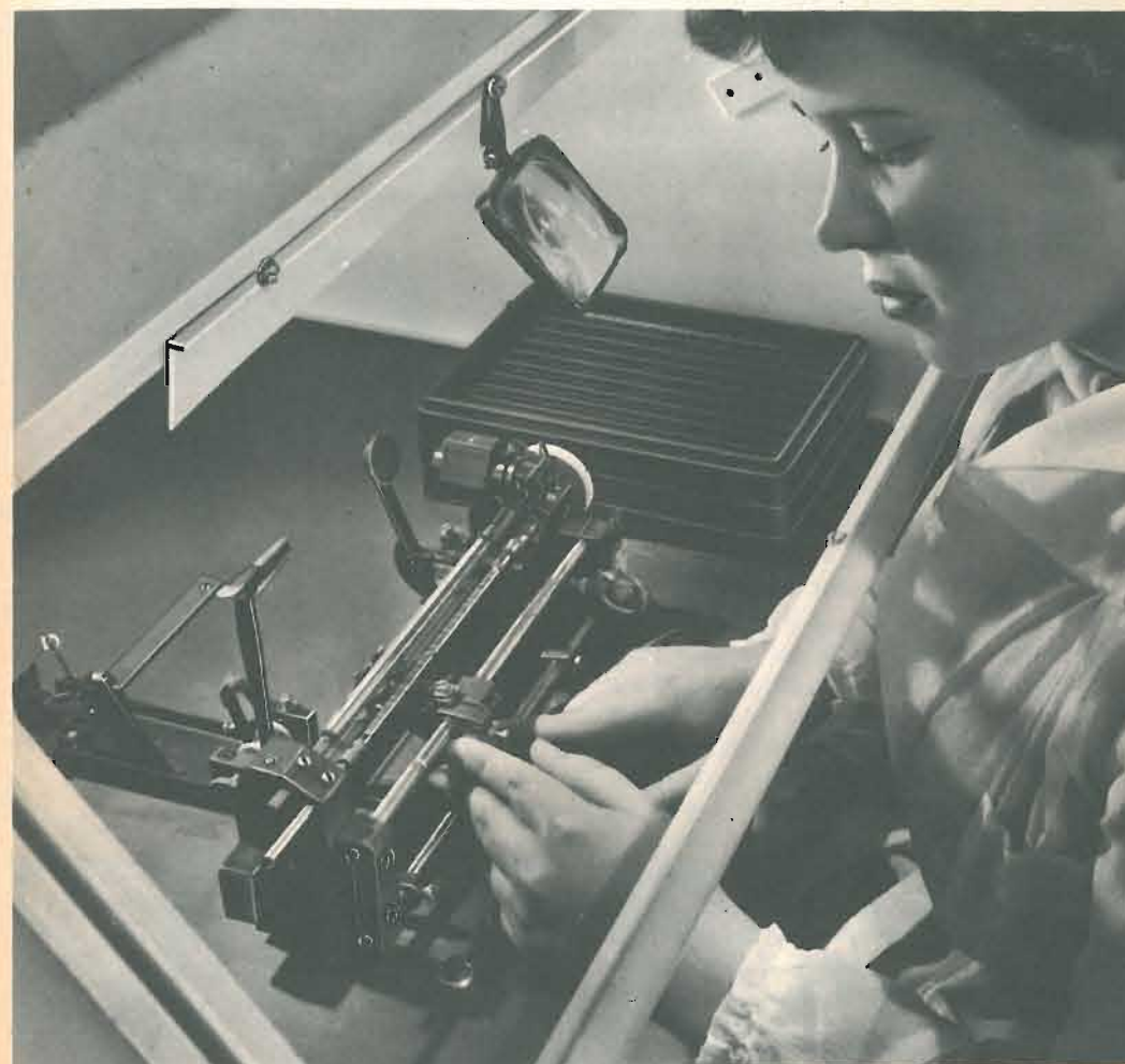
Il filo che torra la griglia a telaio ha un diametro di soli 10 \mu ; può essere visto soltanto in particolari condizioni di illuminazione, viene avvolto su «tela» mediante speciali avvolgitrici come quella indicata in figura.
