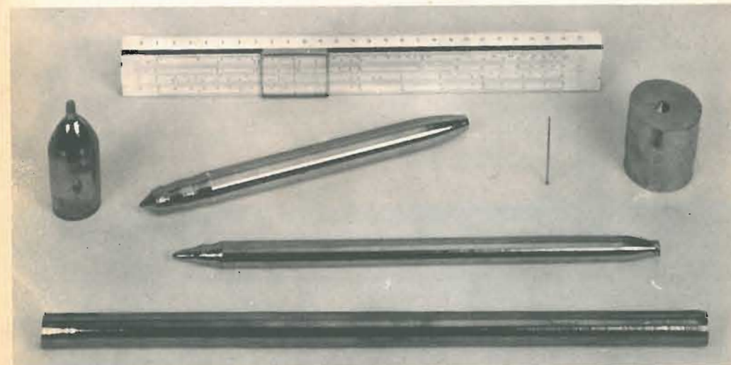
Barre di germanio e di silicio monocristallino ottenute con i metodi illustrati nelle precedenti figure (la barra più lunga è di silicio, tutte le altre sono di germanio).
